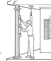
**PASO 3:** Deslice el capitel y la base sobre la columna y asegure con cinta para evitar que se corran. Coloque la columna en su lugar, aplome con el nivel, y quite el armazón o apoyo.
